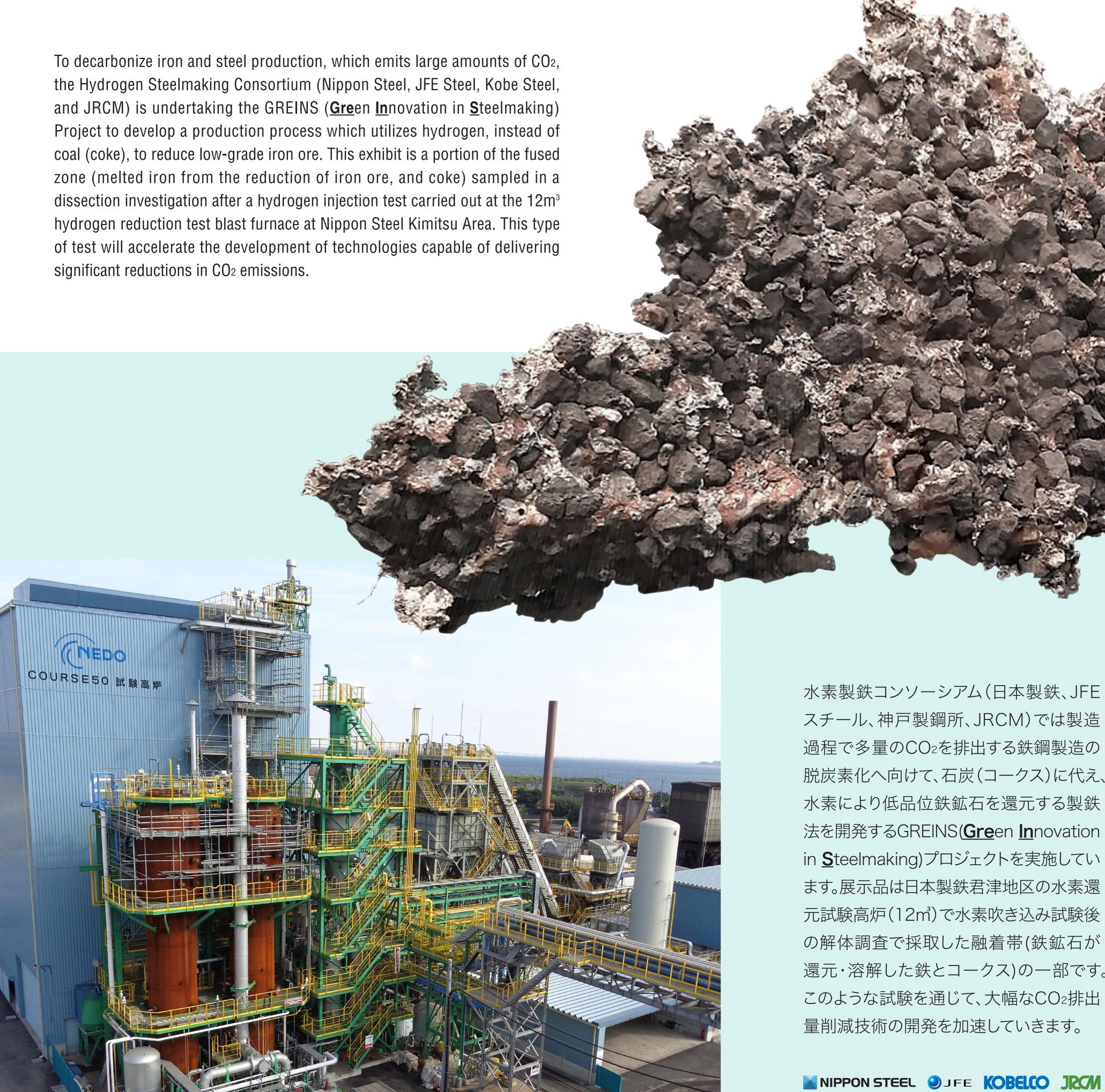
スチール、神戸製鋼所、JRCM)では製造 過程で多量のCO2を排出する鉄鋼製造の 脱炭素化へ向けて、石炭(コークス)に代え、 水素により低品位鉄鉱石を還元する製鉄 法を開発するGREINS(**Gre**en **In**novation in **S**teelmaking)プロジェクトを実施してい ます。展示品は日本製鉄君津地区の水素還 元試験高炉(12㎡)で水素吹き込み試験後 の解体調査で採取した融着帯(鉄鉱石が 還元・溶解した鉄とコークス)の一部です。 このような試験を通じて、大幅なCO2排出 量削減技術の開発を加速していきます。
